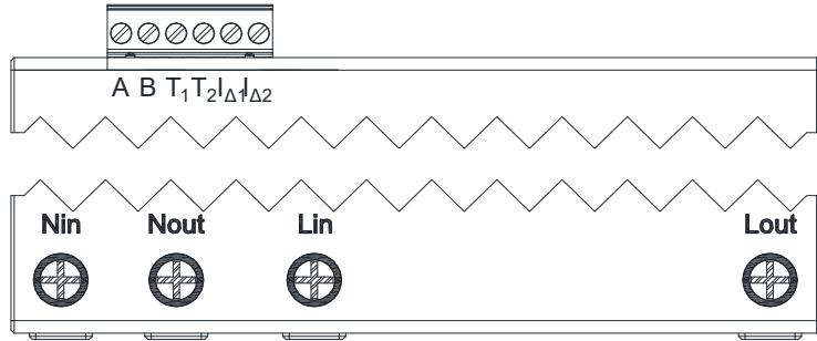
在仪表中，左侧底部端子为强电接线端子，Lin 为单相交流 220V 的 L 线（火线）进线端子，Lout 为单相交流 220V 的 L 线（火线）出线端子，Nin 为零线进线端子，Nout 为零线出线端子。保护器的进出线应根据保护器（或其前端断路器）额定电流选择合适的线径。
