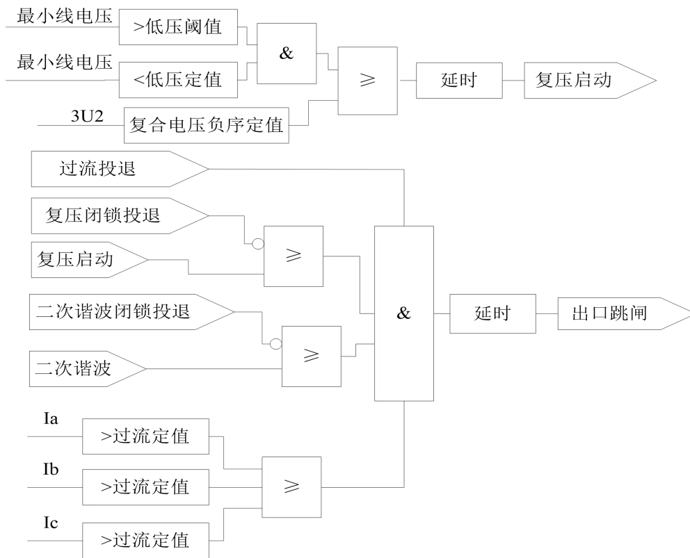
图 2.1 三段式过流保护逻辑
