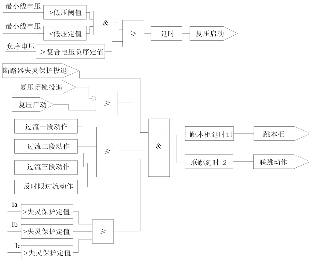
图 1.17 断路器失灵保护逻辑
