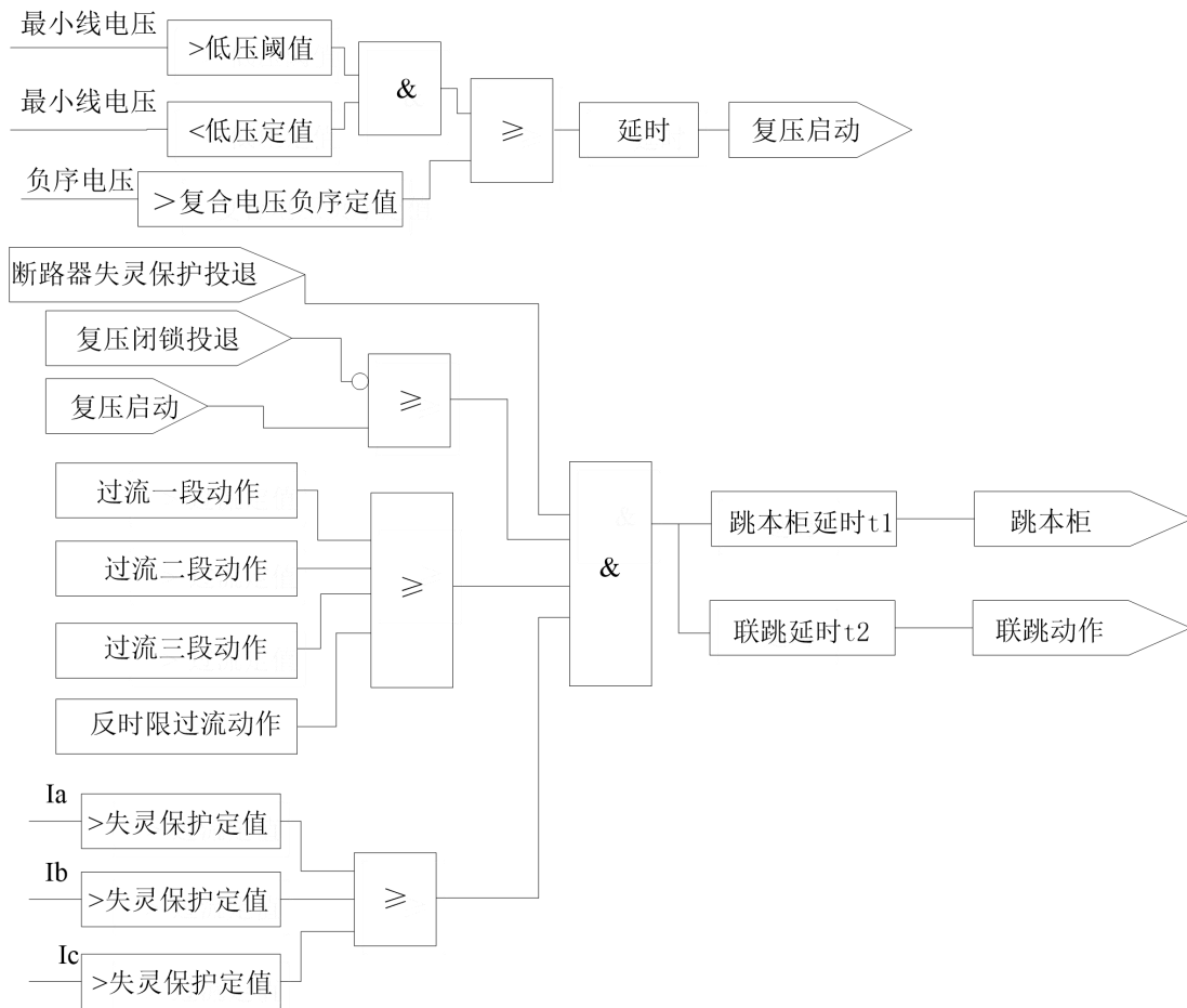
图 3.22 断路器失灵保护逻辑
