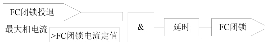
图 6.28 FC 回路配合的过流闭锁功能逻辑
