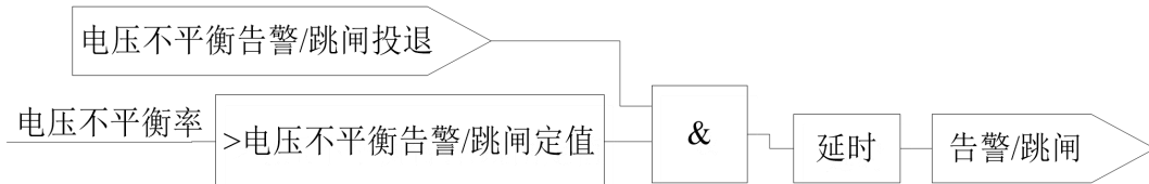
图 6.24 电压不平衡保护逻辑
