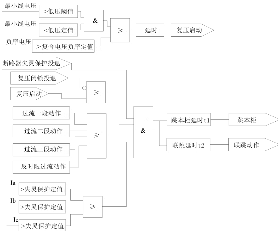
图 2.12 断路器失灵保护逻辑
