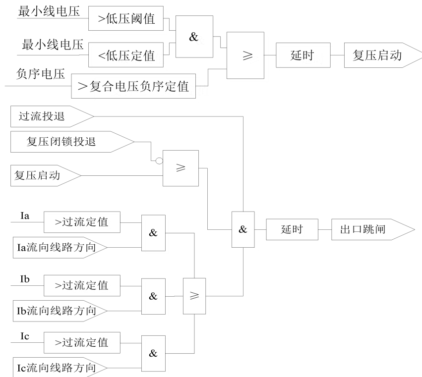
图 4.2 三段式过流保护逻辑
