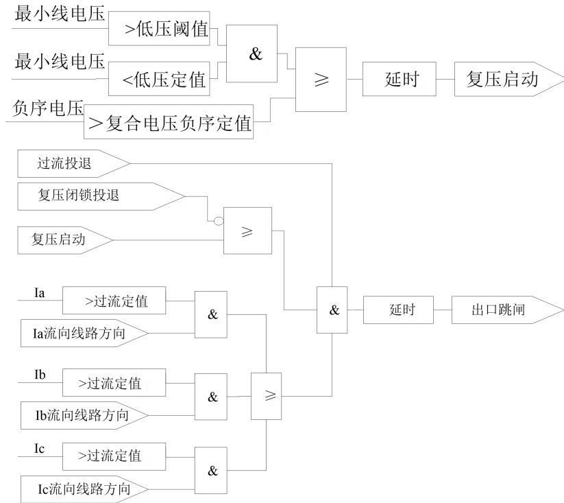
图 8.2 三段式过流保护逻辑
