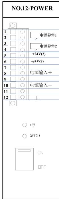
保护装置输入电源的额定电压有 220V 和 110V 两种，订货时需注明，投运调试前请检查所提供电源插件的额定输入电压是否与控制电源电压相同。输出一组 24V(2)电源，其中 12X05 端子为+24V(2)，12X06 端子为-24V(2)。另外经 12X01~02、12X03~04 端子输出两付电源消失告警常闭输出接点，当电源消失后接点闭合输出信号，电源正常时接点是打开的。
