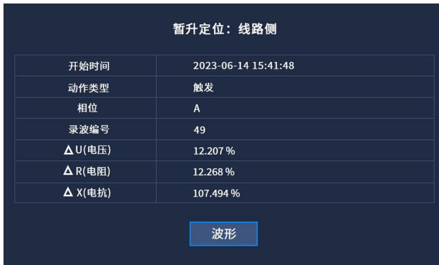
图 4.25(b) 电压暂升源定位-线路侧
