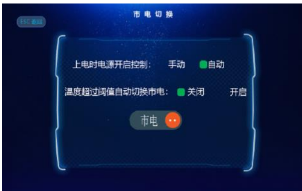
▲ 市电切换：市电和安全电切换操作
